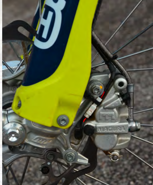
Magura-Bremse mit überragenden Werten für Dosierbarkeit und Wirkung
