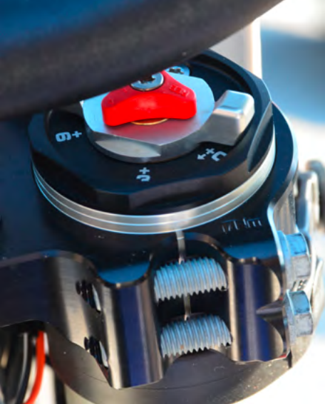
Gabel in Vorspannung, Druck- und Zugdämpfung ohne Werkzeug von oben einstellbar
