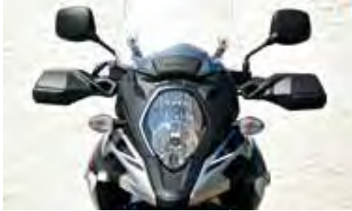
Ebenfalls Halogen-Doppelscheinwerfer, Windabweiser relativ laut, Handprotektoren Serie
