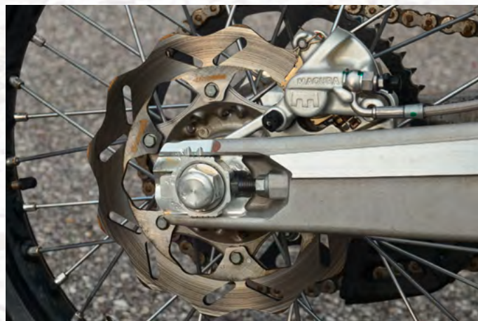
Feinfühlig kalkulierbare Hinterradbremse, ebenfalls von Magura
