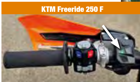
Zwei Mapping-Stufen mit kleiner, aber spürbarer Auswirkung
