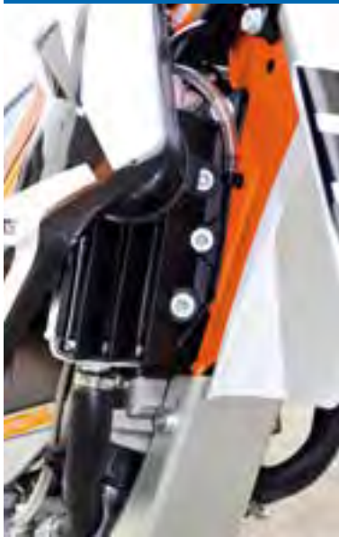
Flüssigkeits-Kühlung für den Elektroantrieb
