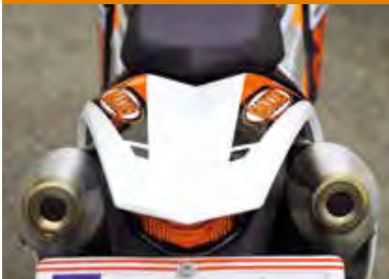
Zwei leichte Alu-Schalldämpfer für verhaltenen Sound
