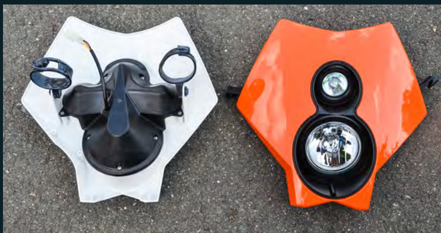
Die Trail Tech X2 Scheinwerfer-Lösung ist adaptierbar, Universal (links) und KTM/ Husqvarna (rechts), die SC4-Lampe High-Beam sorgt für die notwendige Ausleuchtung im Nahbereich, das MR16-Fernlicht ist für höheres Tempo zwingend notwendig
