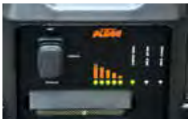
Ladezustands-Kontrolle am Ladegerät
