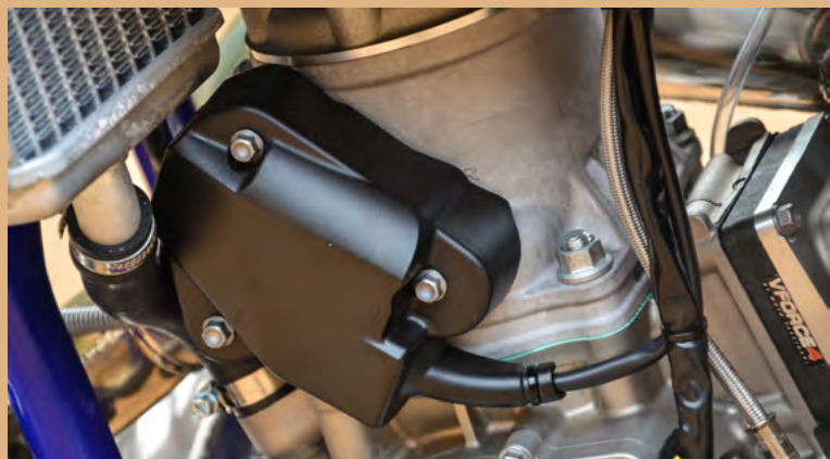
Die Auslasssteuerung wird elektronisch geregelt und arbeitet auf höchstem Niveau
