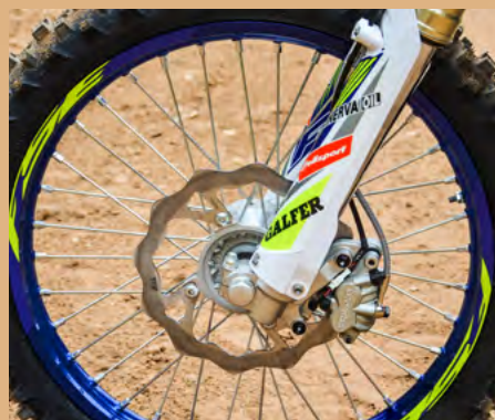
Auch am Vorderrad liefert die geschlossene Bremsscheibe eine überzeugende Vorstellung
