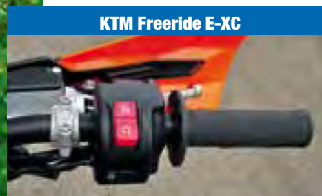
Zwei Schalter zur Aktivierung des Elektroantriebs
