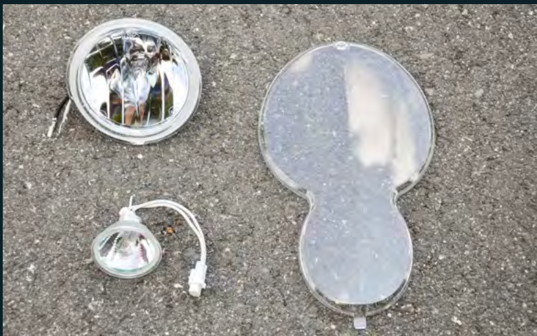
Alle Bauteile sind als Ersatzteil verfügbar: Leuchtmittel und Steinschlagschutz sind für den Notfall wichtig
