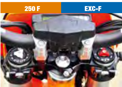
Einstellung der Gabel-Dämpfung komplett von oben ohne Werkzeug
