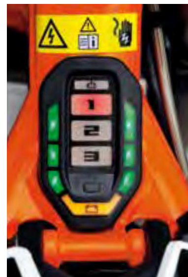
Anzeigen für Fahr-Modus und Ladezustand hinterm Lenkkopf
