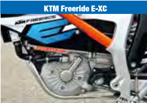
Gegen Staub und Wasser geschützter Elektroantrieb ohne Kupplung und Schaltgetriebe
