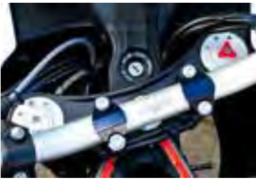
KTM: Gabeldämpfung von oben ohne Werkzeug einstellbar
