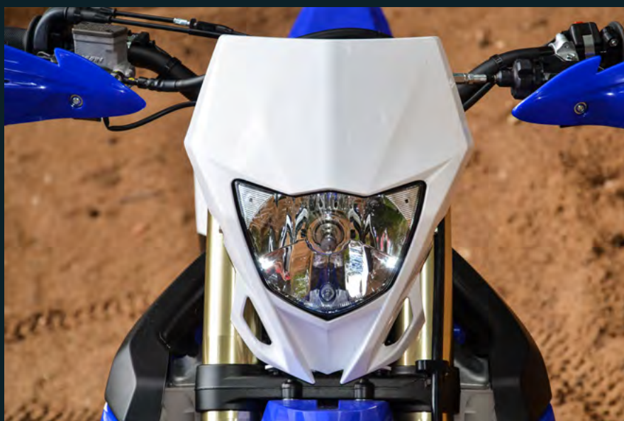
Yamaha WR: Einer der wirksamsten Original-Scheinwerfer an einer Sportenduro, großer Reflektor
