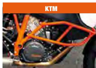
Potenter V-Zweizylinder im unten offenen Gitterrohrrahmen
