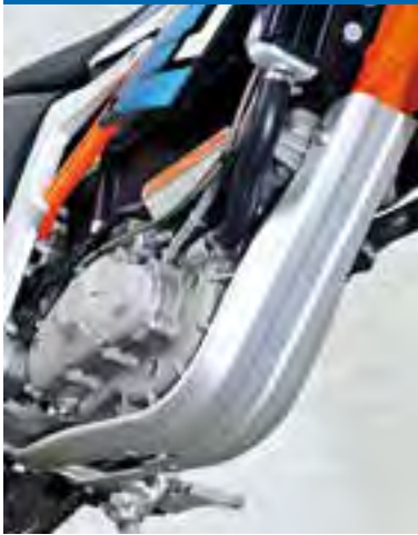
Robuster Leichtmetall-Schutz für den Elektromotor
