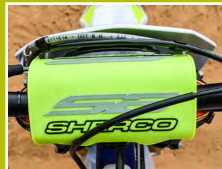
Die Sichtbarkeit des Tachos wird durch das Lenkerpolster sowie Leitungen und Züge vollständig verhindert
