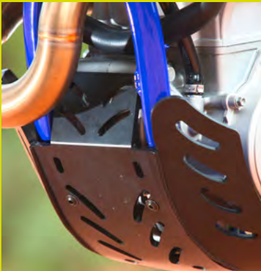
High-End: Massiver AXP-Kunststoff-Motorschutz serienmäßig
