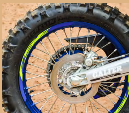
Geschlossene Bremsscheibe mit guten Verzögerungswerten, Vorteile bei widrigen Bedingungen
