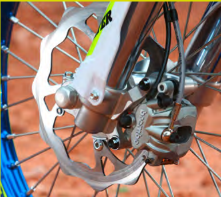
Cross-Country: Vorn und hinten geschlossene Bremsscheibe
