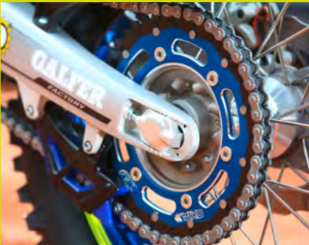
Supersprox-Stealth-Design: Alu-Träger mit Stahl-Kettenrad-Ring für erhöhte Lebensdauer
