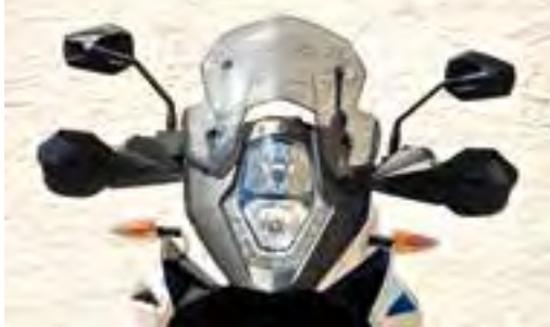
Akzeptabler verstellbarer Windabweiser, H7-Doppelscheinwerfer, Handschützer serienmäßig
