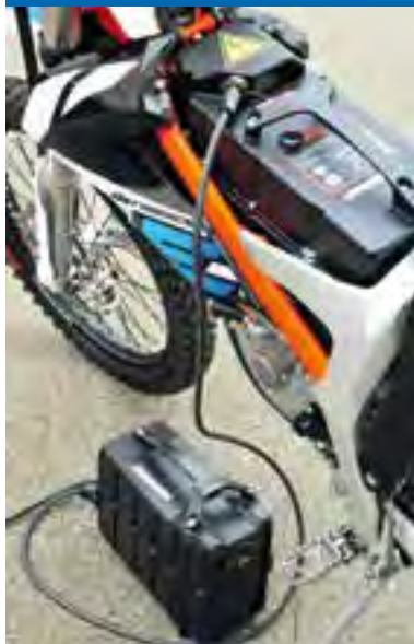
Den Akku laden, ohne das PowerPack auszubauen
